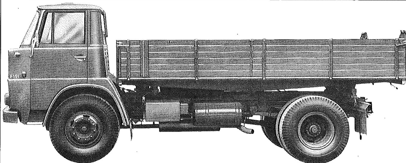
**Diesel-Motor · 6 Zylinder · 4-Takt · 230 PS bei 2150 U/min****Nutzlast: 8,125 t****Triebwerk****Motor**
